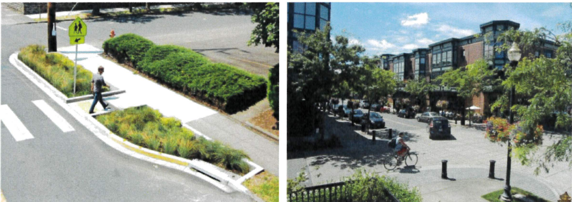
Figure 34. Trottoirs élargis avec avancées au niveau des passages piétons, bollards aux intersections, Portland, États-Unis
